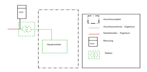
Richtwert: ab 300 kW Anschlussleistung ( $\cos \varphi = 0.9$ )
